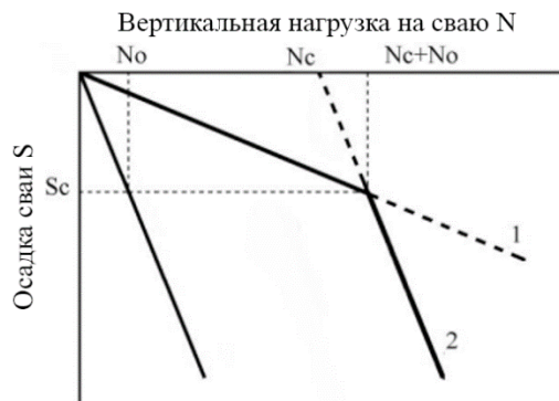
Рисунок Д.1 – Схема осадки в зависимости от этапов нагружения сваи:
