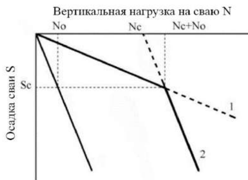
Рисунок Д.1 – Схема осадки в зависимости от этапов нагружения сваи:
